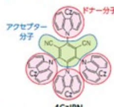
■図4 TADF発光材料の構造。ベンゼン環の6つの水素のうち2つがシアノ基(CN)に置き換わった構造をしている。
