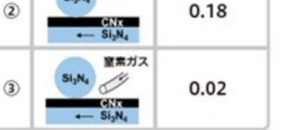
摩擦のない状態での摩擦特性を調べた実験結果。摩擦係数の値が低いほど摩擦が小さい。①は窒化ケイ素(Si<sub>3</sub>N<sub>4</sub>)のボールを固定し、窒化ケイ素のディスクを回転させて摩擦特性を調べたもの。②は回転させるディスクの表面を窒化炭素(CN<sub>x</sub>)で削ったもので、摩擦係数が大幅に小さくなっている。③は②にさらに窒素ガスを吹き付けたもので、摩擦係数は1枚小さくなっている。
