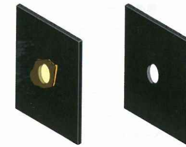
図2 小さな試料を測るためのマスク。
