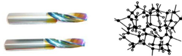
図2 DLCコーティングした切削工具と、DLC膜のアモルファス構造の模式図
