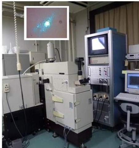
図1 顕微ラマン散乱分光装置 (堀場製作所 T64000), 画面上のビームサイズは1 \mu\text{m}
