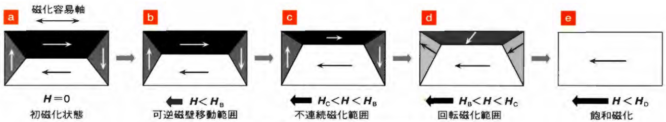
図14 初磁化曲線の磁壁移動・磁化回転による説明
