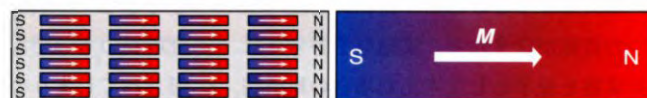
図3 磁性体の内部には多数の原子磁石があり、隣合う原子磁石の磁極は互いに打消し合い両端に磁極が生じる
