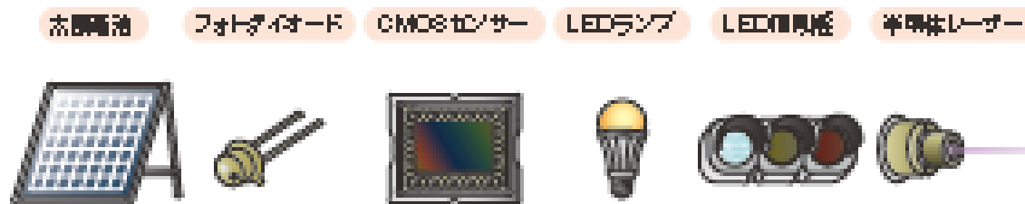
図3 ダイオードの光特性を利用したデバイス是非常に多い
