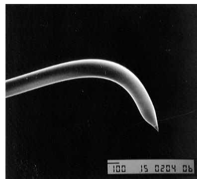
図7 曲げて先端部を絞ったSNOM用ファイバ・プローブ
