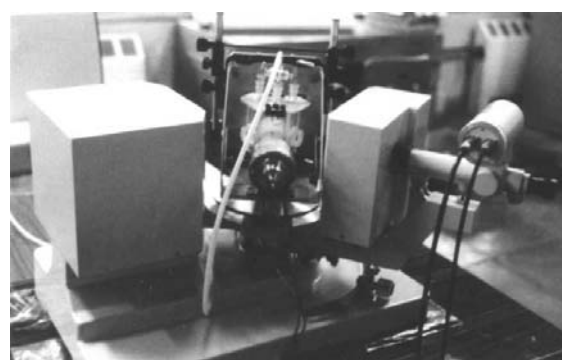
写真 2 エリプソメトリーによる下地の光学定数の測定
