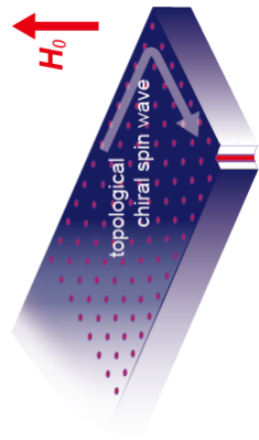
図1 トポロジカルマグノンニック結晶の理論提案 [15] トポロジカルなスピン波が縁に沿って時計回りに流れる。
