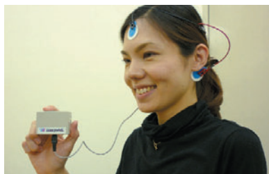
「夢眠計」は、電極を一對装着するだけなので、睡眠を阻害することが少なくなると期待できます。
